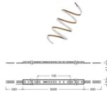
Technische Daten Ledvance LED-Streifen Value 1000 40W 3720lm 24v - 827 | IP66 - 5M/10mm
