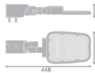
**Technische Daten Ledvance LED-Straßenbeleuchtung Area Value klein SPD Aluminium Grau 45W 5850lm 160x58D - 730 | IP66 - Symmetrisch**
