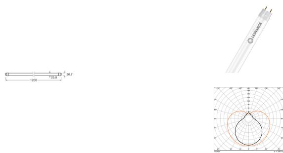
**Technische Daten Ledvance LED Röhre T8 EM Ultra Output Value Conventional (EM), Mains (AC) Ultra Output 20W 2400lm - 865 Tageslichtweiß | 120cm - Ersatz Für 36W**
